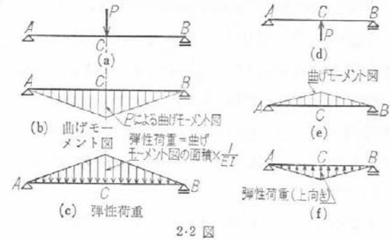
また、2.2 図(b)のように、曲げモーメント図がはりの下側にえがかれるときには、弾性荷重を下向きに、2.2 図(c)のように作用させる。
